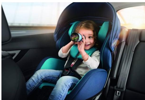
Существует несколько типов автокресел, каждое из которых предназначено для ребенка определенного возраста, роста и веса. Помните, что спинка детского автомобильного кресла должна предельно прилегать к спинке сидения машины. Глубокая посадка в кресле обеспечит наибольшую защиту при столкновении вашему малышу.
